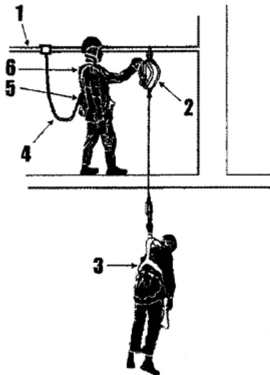
Система спасения и эвакуации, использующая средства защиты втягивающего типа со встроенной лебедкой.
